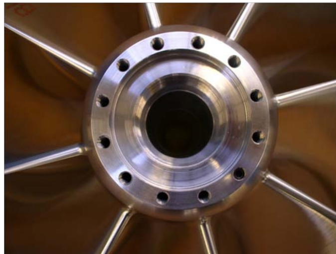
Abbildung 48: Bohrlöcher mit Innengewinde für das Balancieren
