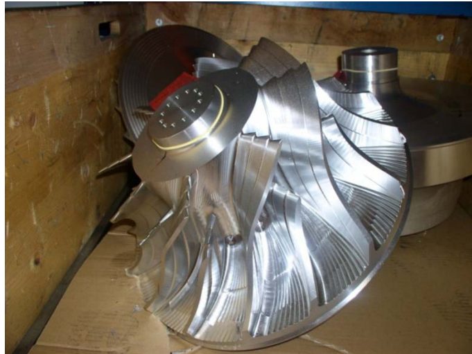
Abbildung 46: Vorgefrästes Verdichterrad TPL77 (Wärmebehandlungskontur)
