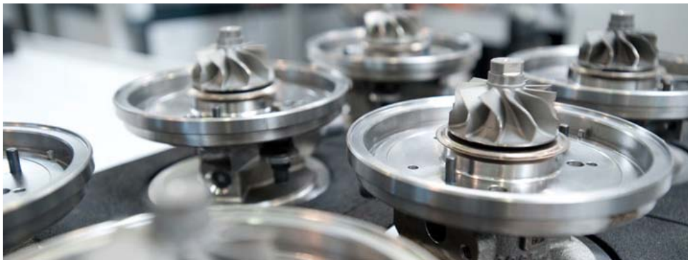
Abbildung 19: Nachbearbeitung von BMTS Turbinenrädern 20
