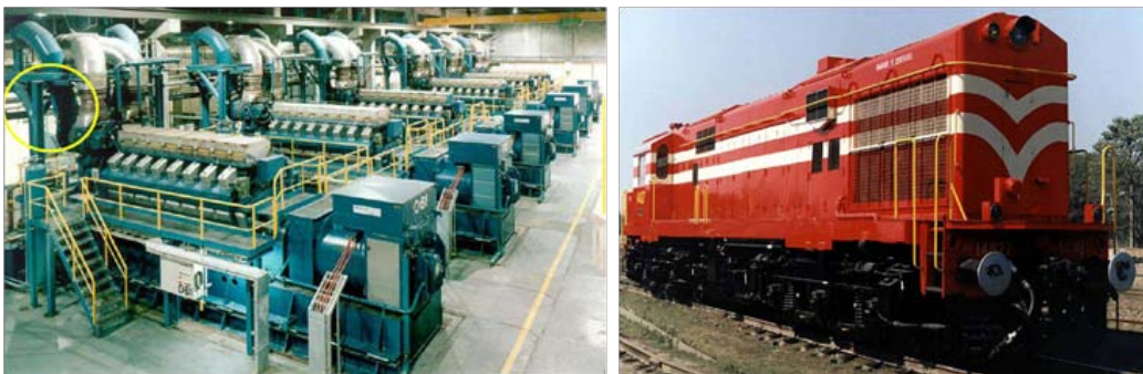
Abbildung 13: Dieselmotoren und Diesellokomotiven mit ABB-Turboladern
