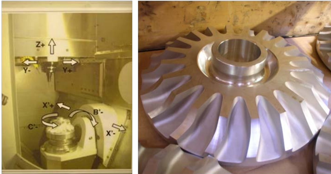
Abbildung 47: Fünfachsigige CNC Fräsmaschine(links) und Vorschaltrad (rechts)
