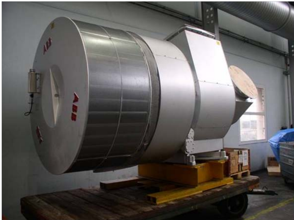
Abbildung 58: Fertiger TPL77 Turbolader
